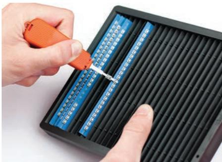
Вставьте планки с символами в поддон для планок. Код 118. После того как планки с нужными символами вставлены, можно извлекать маркировочные элементы с помощью язычка (коды 119/15U или 119/30U), в зависимости от длины таблички.
