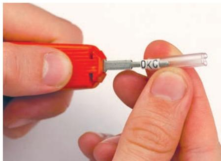
Символика, составленная из одного или более элементов, полностью набирается непосредственно на язычок, с которого она затем вводится в полость трубочки.
