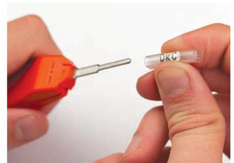
После введения маркировочных элементов в верхнюю полость трубочки, производится легкое нажатие большим пальцем левой руки на конец трубочки с тем, чтобы вытащить язычок из полости трубочки.
